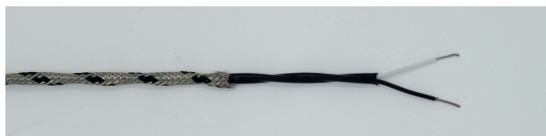
Isolamento primario in teflon isolamento secondario in teflon Schermo in calza di rame stagnato Colorazione a norme ANSI MC96.1
